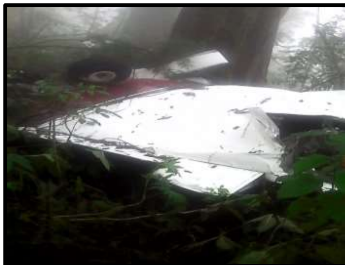
Fotografía No. 8 Daño en ambas alas por el golpe en los árboles.
