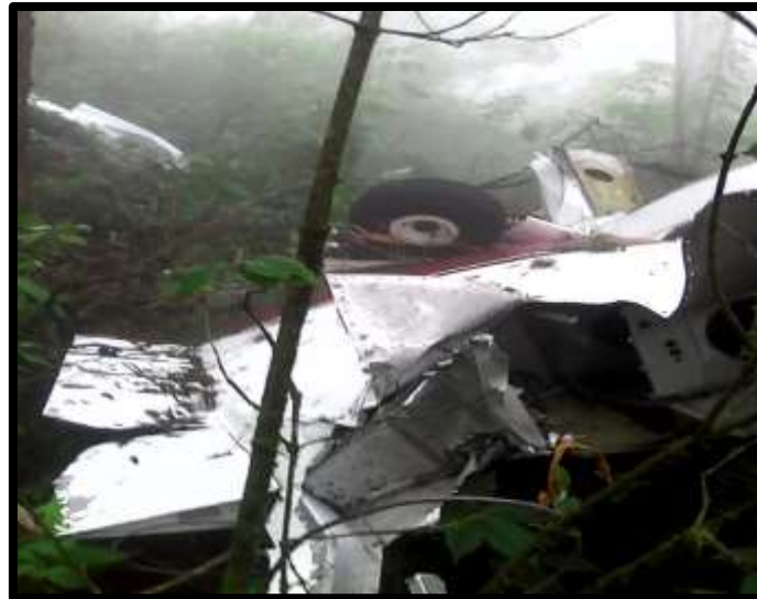
Fotografía No. 3 Ala derecha destruida por el golpe con los arboles.
