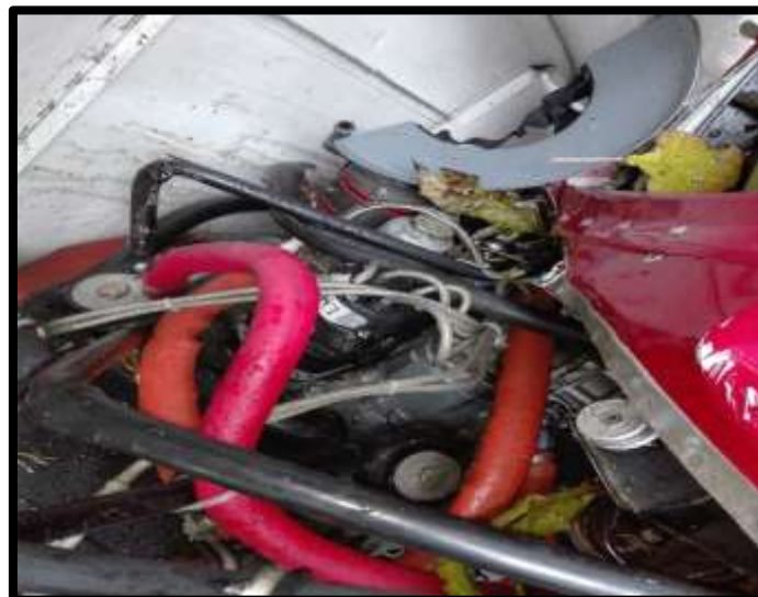
Fotografía No. 10 Daños a la bancada y montantes del motor desprendido por efecto del impacto.
